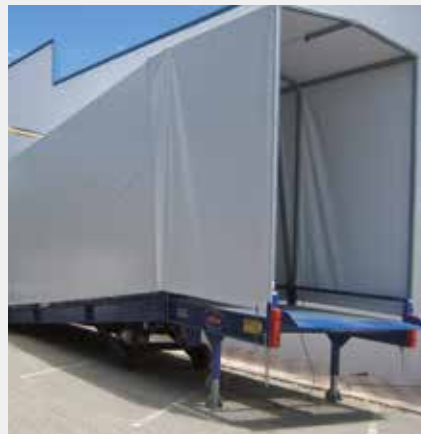
Rampa móvil con cubierta de PVC.
