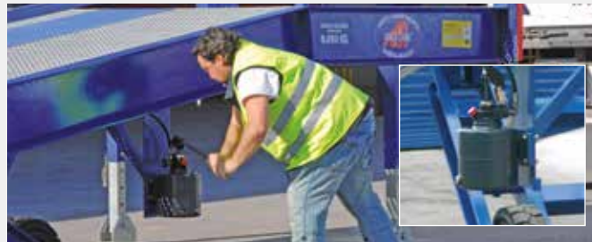
Accionamiento por bomba manual.
