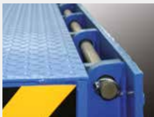
Ejes del labio y bisagras: bicromatado electrolítico para prevenir la corrosión. Bisagras autolimpiables. (Eje Ø29 mm.)
