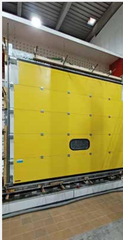
Prueba de permeabilidad del agua y aire.
