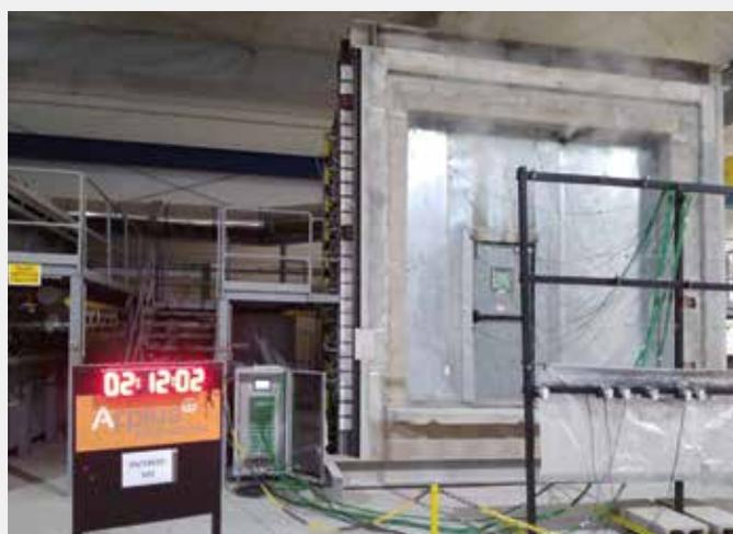
Ensayo **EI-120** con puerta de paso sin zócalo inferior.
