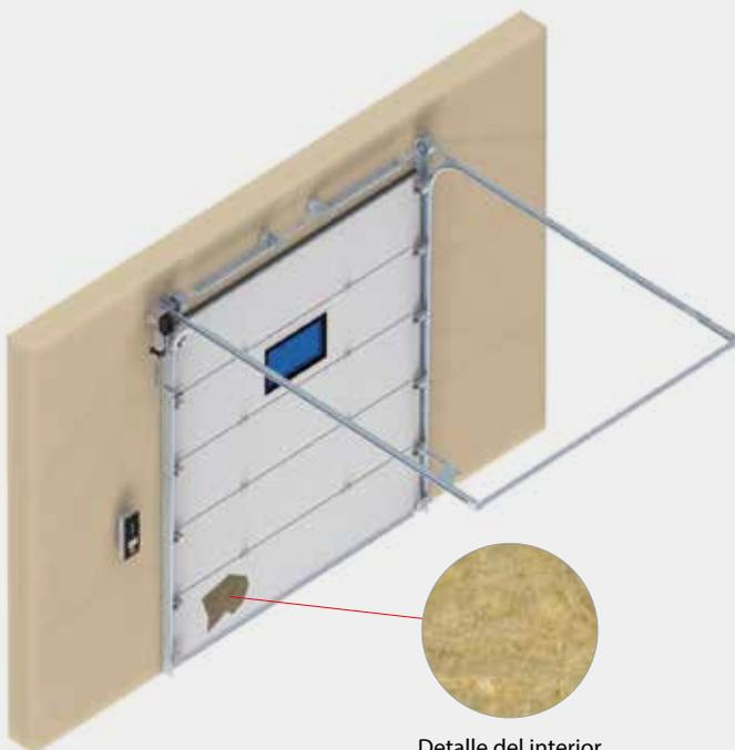
Detalle del interior del panel relleno con lana de roca.
