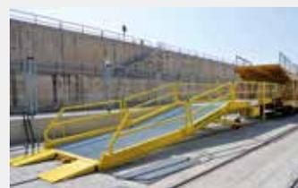
Rampa móvil para carga y descarga en trenes.
